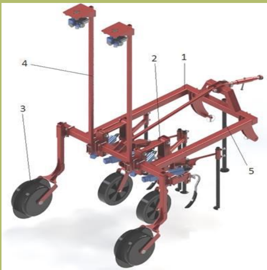
Fig.3. Modelul experimental de echipament inteligent de prășit, cadru (1) pe care se montează două secții de prășit (2), două roți (3) de deplasare și reglare a adâncimii de lucru, doi suportți (4) pentru camerele de captare a imaginilor și un picior de staționare (5).
