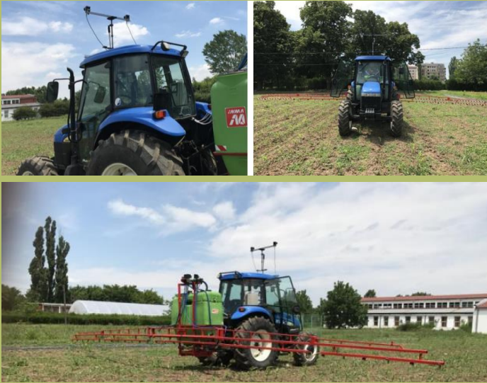
Fig.5. Modelul experimental de sistem inteligent pentru controlul activ al lucrarilor de realizare a tratamentelor fitosanitare in culturile de camp
