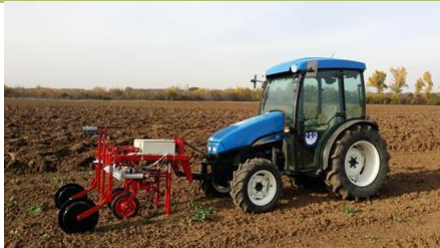
Fig.3. Modelul experimental de echipament inteligent de prășit, cadru (1) pe care se montează două secții de prășit (2), două roți (3) de deplasare și reglare a adâncimii de lucru, doi suportți (4) pentru camerele de captare a imaginilor și un picior de staționare (5).
