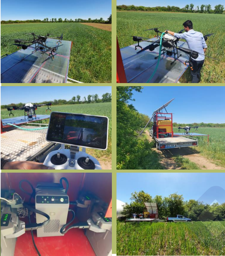
Fig.9. Modelul experimental de sistem pentru protecția culturilor de câmp conform "Agriculturii 4.0" destinat fermei SMART
