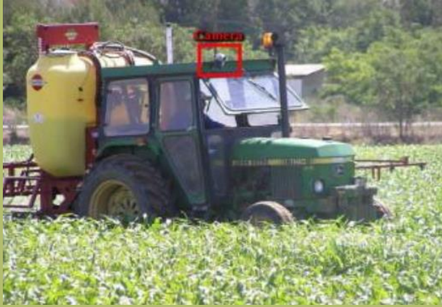
Fig.4. Amplasarea camerei orientata in directia de înaintare a tractorului pe acoperiș.
